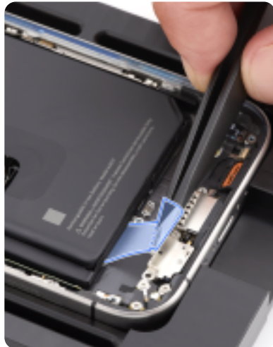
De iPhone-batterij wordt vastgezet met een geavanceerde lijm die loslaat wanneer je die in een bepaalde richting uitrekt. Zo kan de batterij makkelijk worden vervangen.
