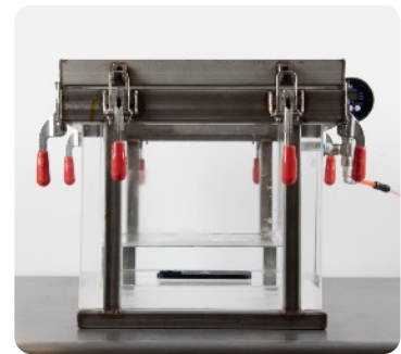
Per testare la protezione in caso di immersione in acqua IPX7/8, Apple immerge l'iPhone all'interno di un recipiente pressurizzato che simula la pressione che si prova sott'acqua.
